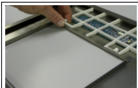
Levante a proteção da placa de controle
